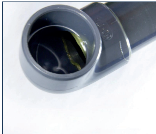
Prawidłowo wykonane połączenie klejone.
